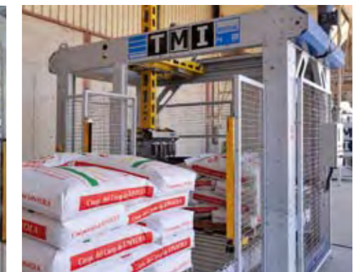
Palettisation entièrement automatisée
