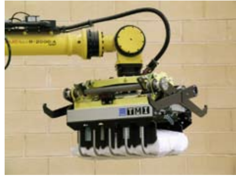
Pinza central, sacos de boca abierta.
