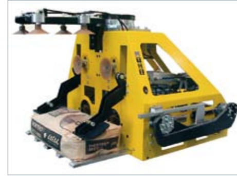
Pinza lateral, sacos de válvula.
