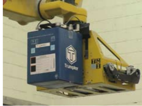
Pinzas versátiles para sacos, cajas y palets.
