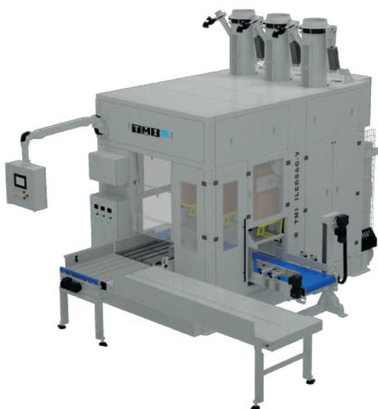
Ensamadora automática para sacos de válvula mediante fluidificación, carenada, con múltiples puntos de llenado, alimentados por un solo brazo robótico y con cierre por ultrasonidos
